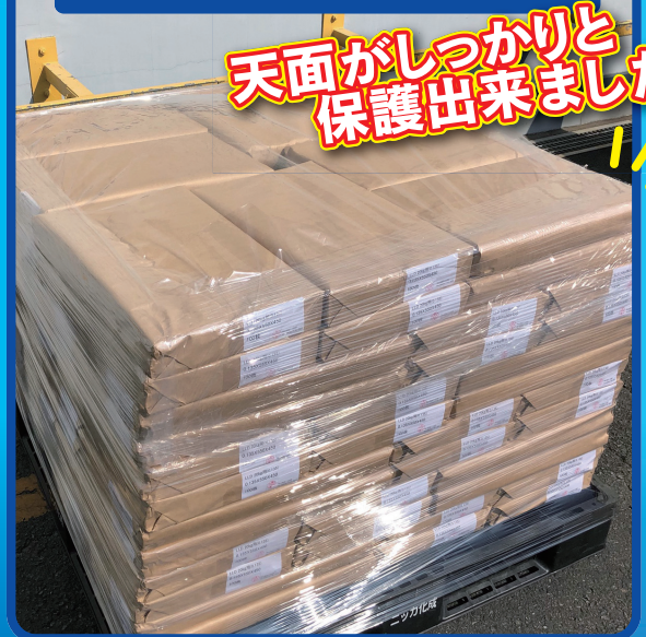
トップシートを掛けたあと、 ストレッチフィルムを巻いた状態
